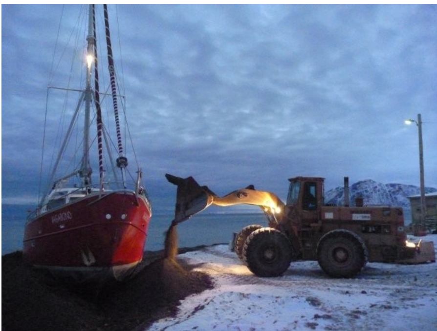
Vagabond, en place pour l'hiver 2012-2013; ajout de graviers et de sable pour isoler la coque.
